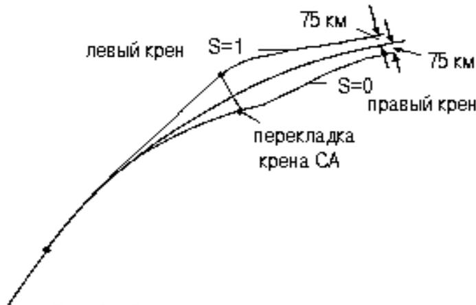
Рис. 8-12: Начальный крен СА определяет положение точки посадки относительно трассы полета
