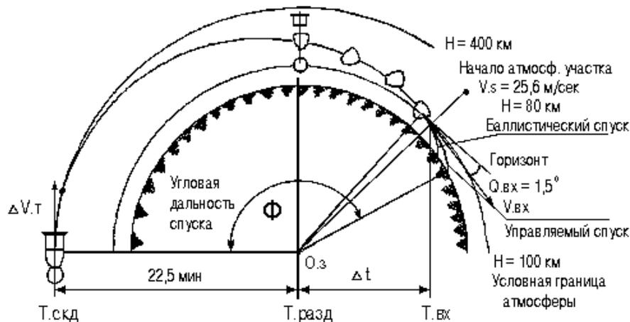
Рис.8-14: Штатная схема спуска
