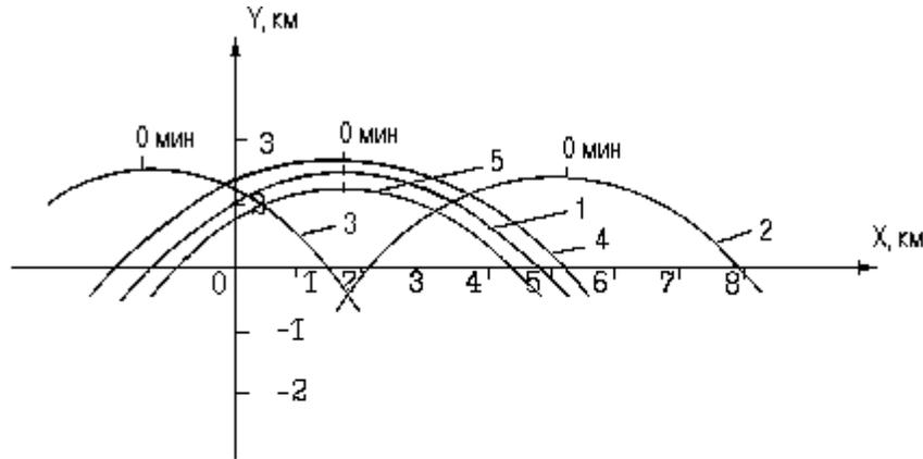
Рис.8-11: Схема баллистического прецизионного сближения (БПС)
