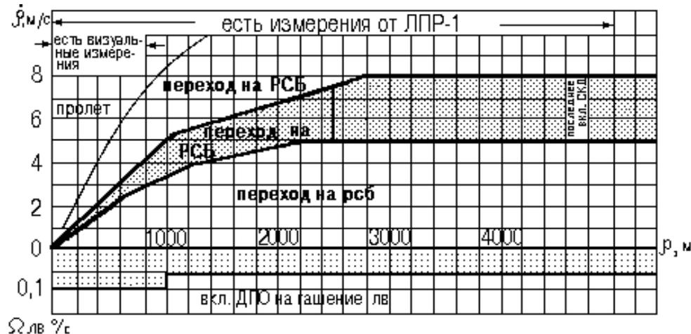
Рис.8-8: Закон управления при ручном сближении
