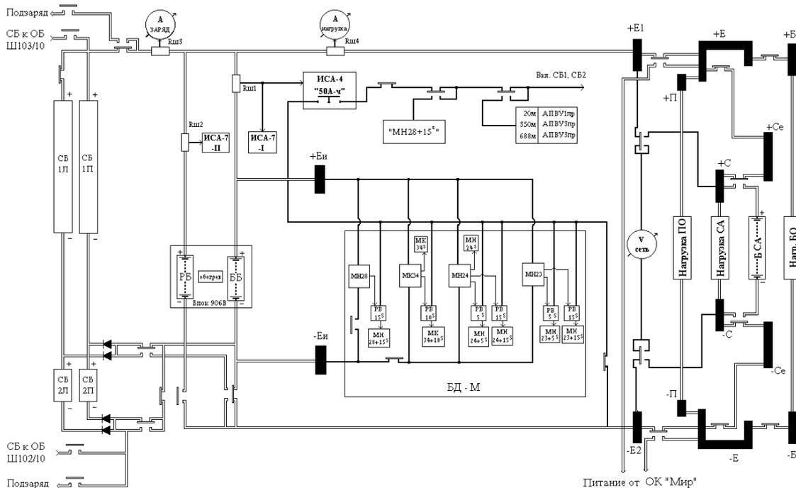
Fig. 1. The СЭП System Block Diagram
