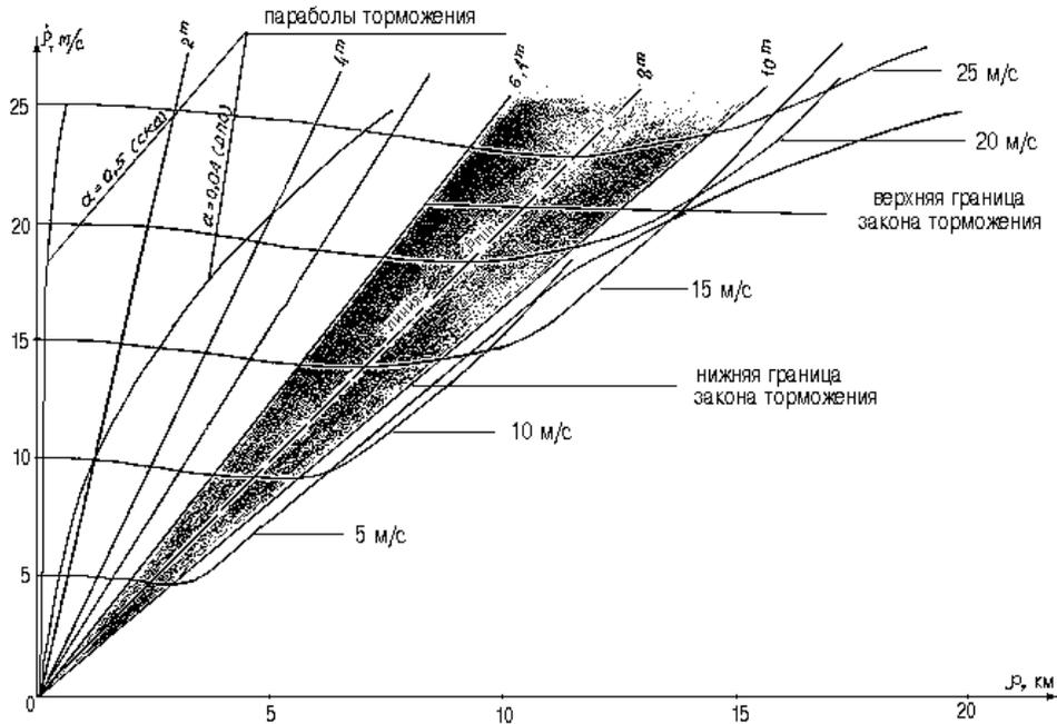
Рис.8-7: Зависимость  $\dot{\rho}$  от  $\rho$  для номинальных попадающих траекторий при  $\Delta V_{np}=5, \Delta V_{np}=10, \Delta V_{np}=15, \Delta V_{np}=20, \Delta V_{np}=25$  м/с
