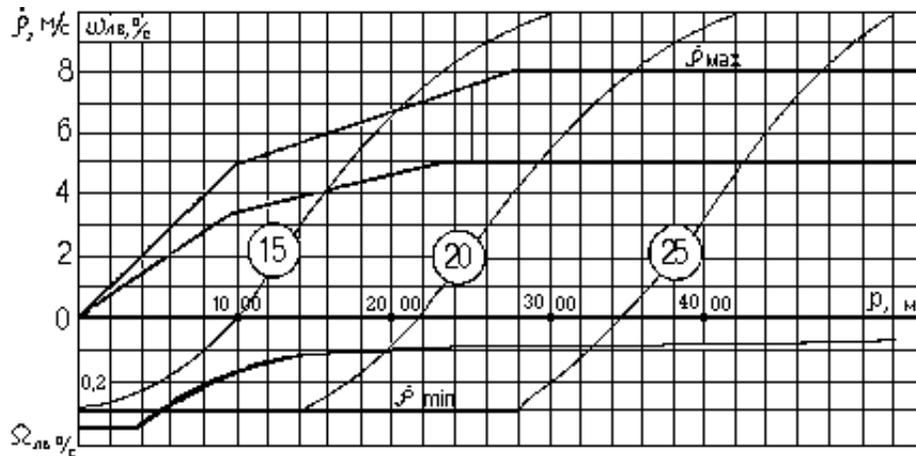
Рис. 8-9: Критерии перехода в режим ручного управления и потребное время на ручное сближение до зависания
