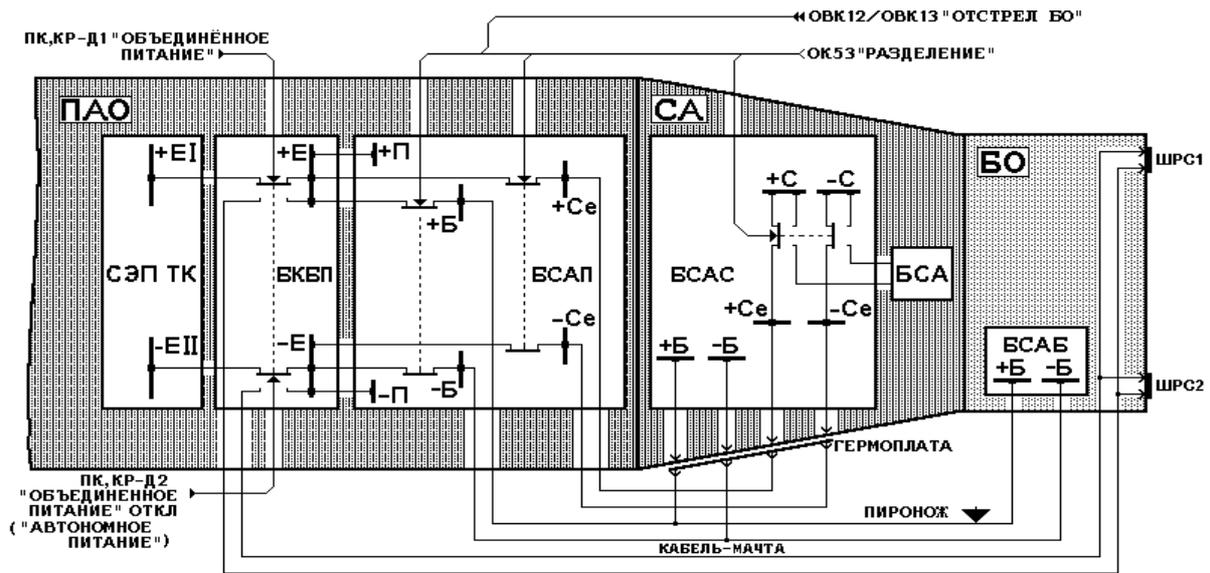
РИС. 2. РАСПРЕДЕЛЕНИЕ ШИН ЭЛЕКТРОПИТАНИЯ ОТСЕКОВ
