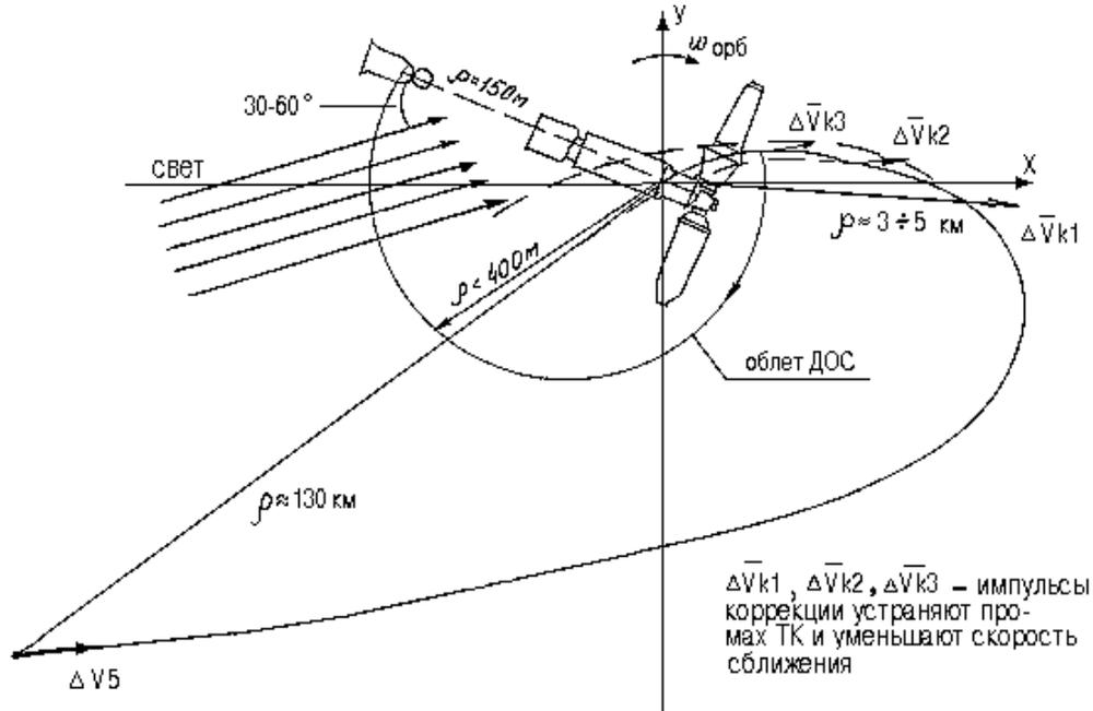
Рис.8-3: Автономный участок сближения после импульса  $\Delta V.5$
