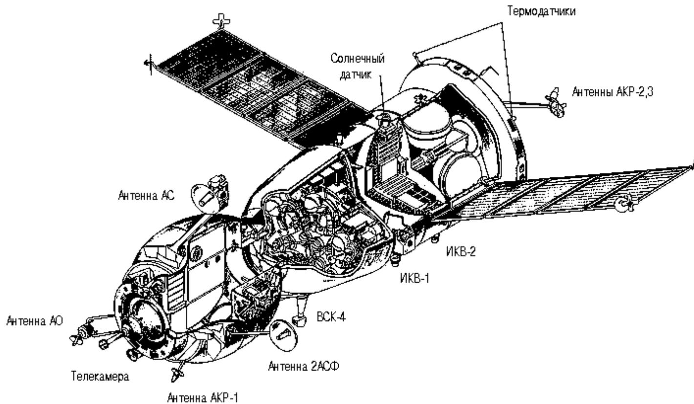
Рис. 2-2 : Внешний вид транспортного корабля "Союз ТМ"
