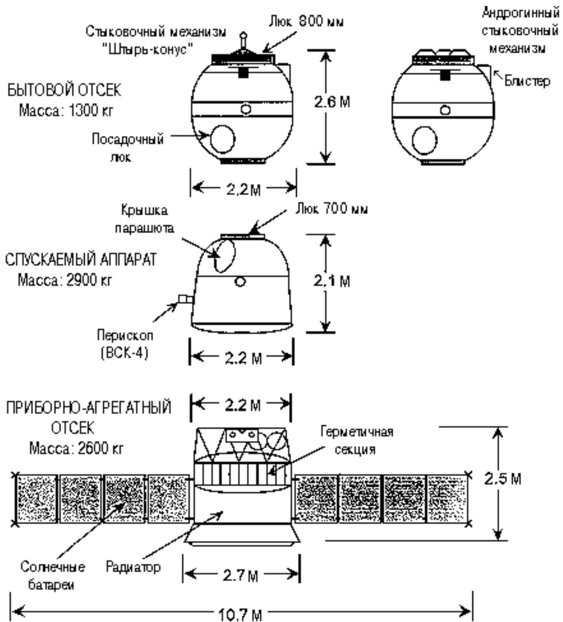
Рис. 2-1: Состав транспортного корабля "Союз ТМ"
