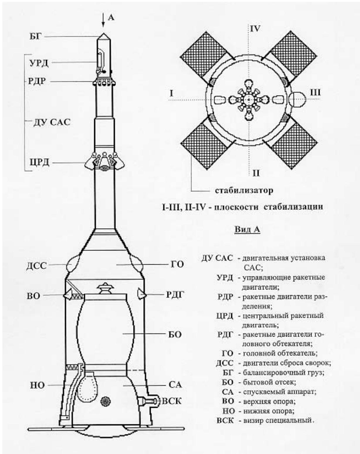
Fig. 1. CAC System Diagram.
