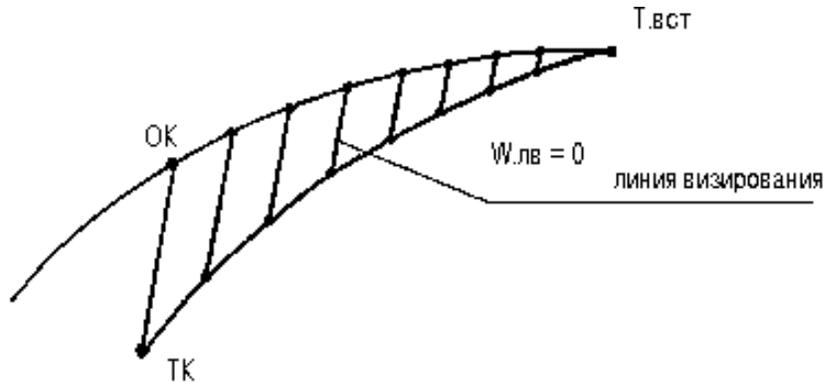
Рис.8-6: Инерциальное параллельное сближение
